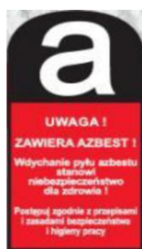
Rysunek 5. Wzór prawidłowego oznaczenia wyrobów/odpadów zawierających azbest
