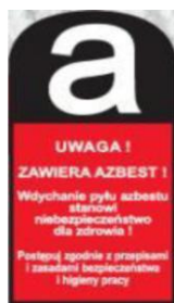
Rysunek 5. Wzór prawidłowego oznaczenia wyrobów/odpadów zawierających azbest
