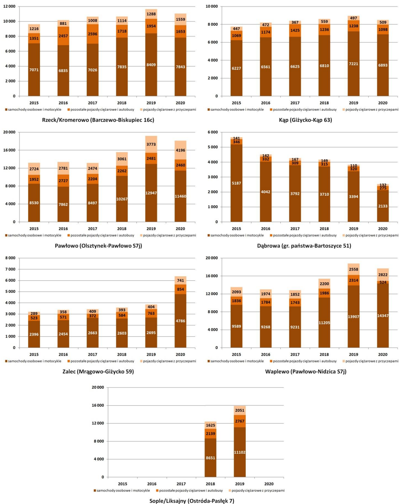
Ryc. 6.18 Natężenie ruchu według kategorii pojazdów na stacjach ciągłych pomiarów ruchu w województwie warmińsko-mazurskim w okresie 2015-2020.
