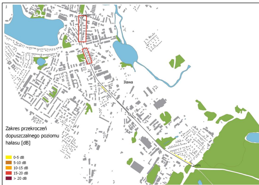
Ryc. 8. Zasięg przekroczeń hałasu drogowego przy DW 536 (Iława - ul. Lubawska) po wdrożeniu ograniczenia prędkości do 40 km/h w ciągu całej doby - wyniki symulacji komputerowej. Zakres zmian - por. z ryc. 7.
